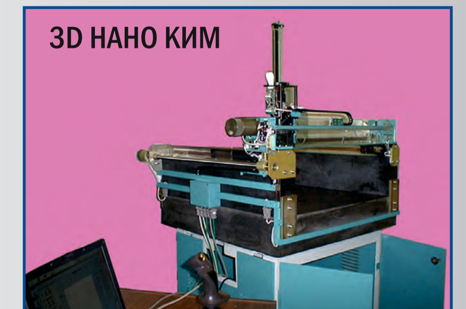
Ультрапрецизионная трехкоординатная наноизмерительная машина голографическая для измерения деталей космических изделий (мировой рекорд \pm 1,2 мкм)
