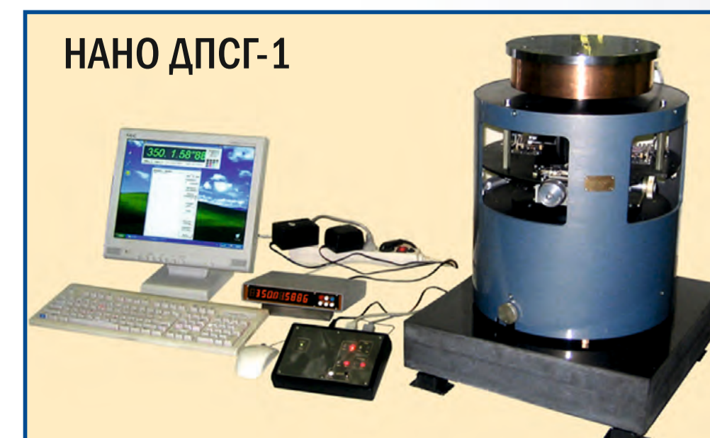
Ультрапрецизионный двухшпиндельный наноизмерительный поворотный стол голографический для сертификации управляющих электродвигателей в ракетостроении (мировой рекорд \pm 0,2'' )
